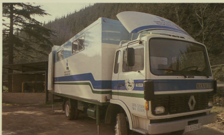
Laboratorio móvil de verificación de equipos de medición de los usuarios.
