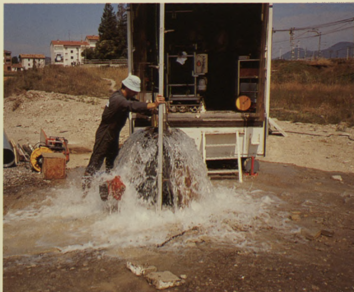
Testificación geofísica en sondeo artesiano, en Nandares de la Oca. Caudal surgente de 140 litros/segundo.
